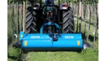
**Gli scalzatori (aratrini) rivoltano la zolla e vanno più in profondità permettendo interventi più distanziati nel tempo. A destra trinciapacciamatrice.**
