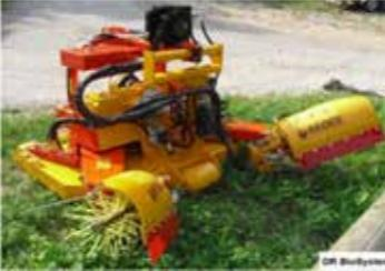
**Minicingolato con tricia laterale rientrante, tricia doppio rientrante e tricia centrale con flagelli laterali rientranti.**
