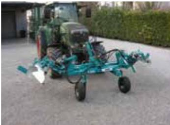
**Alternative già presenti nei comprensori viticoli in particolare di pianura: disco motrice, la lama ed il vomere tutti doppi e dotati di tastatori per il rientro automatico.**
