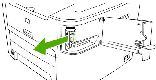
3. Nella fessura interna dello sportello della cucitrice inserire un vassoio da 1.500 punti metallici.
